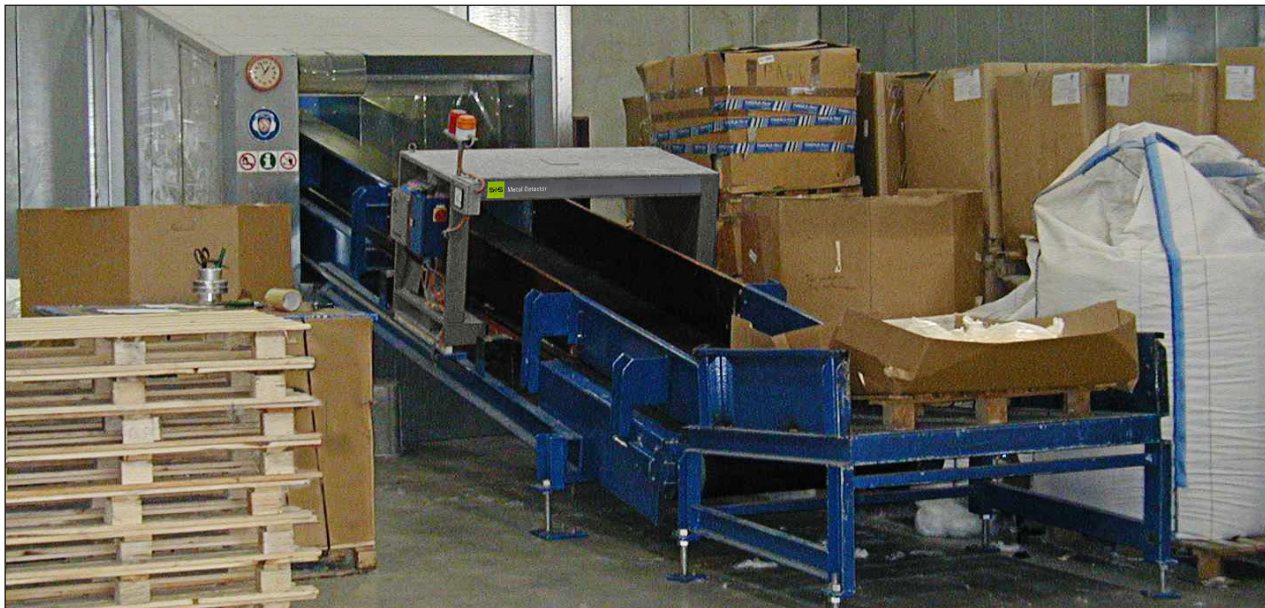
Exemple: Détecteur de métaux type tunnel DLS pour analyser des matériaux de recyclage avant broyage. (ancienne version)
